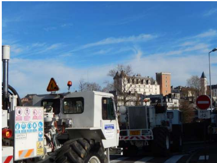
Figure 9: Exemple de Vibreur Type IVI MARK 4 Y2400, insonorisé
