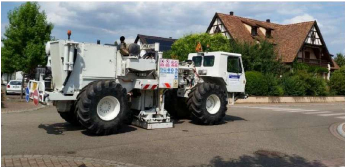
Figure 3 Exemple de camion vibrateur type Birdwagen MARK IV, insonorisé.
