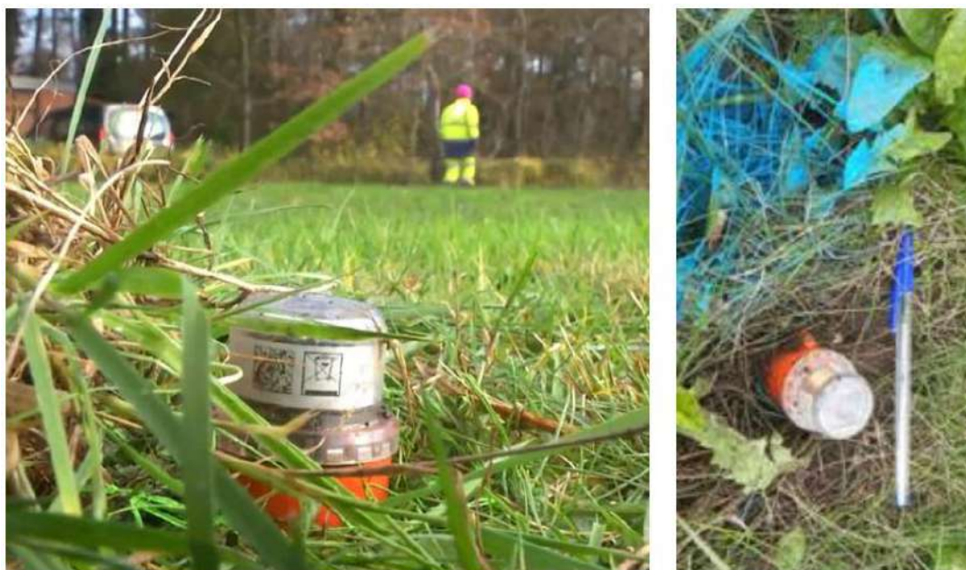
Figure 4 : Géophone dernière génération (STRYDE).
