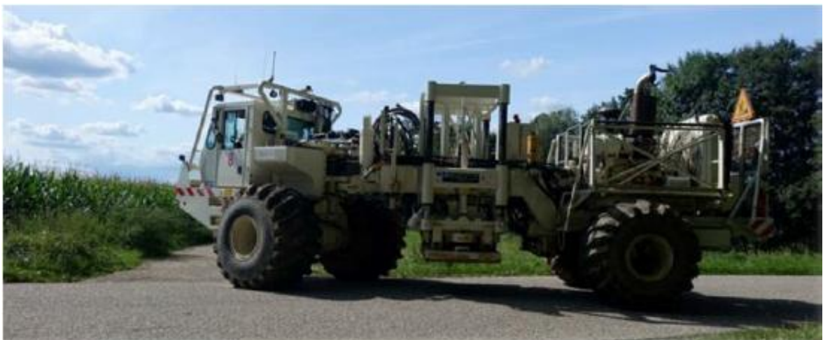
Figure 9 Camion-vibreur type M26
