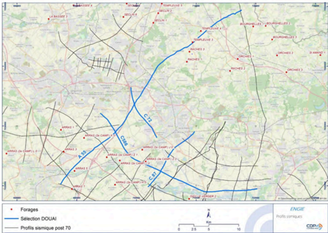
Figure 38 - Lignes sismiques retraitées dans le cadre du projet géothermique de Douai (Source : CDP Consulting)
