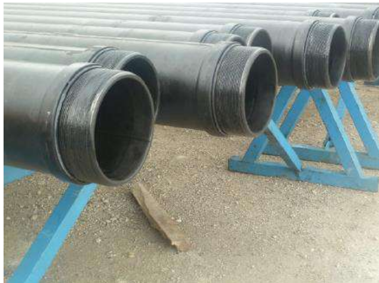
Photo de tubes de la colonne d'exhaure
