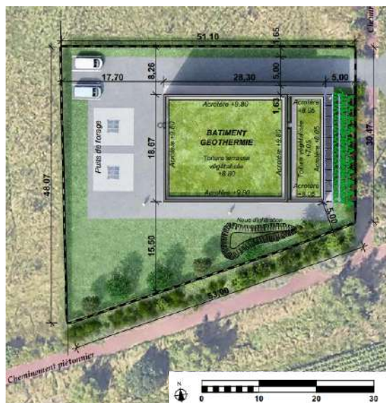
Localisation des deux caves têtes de puits et de la centrale géothermique (vue aérienne).
