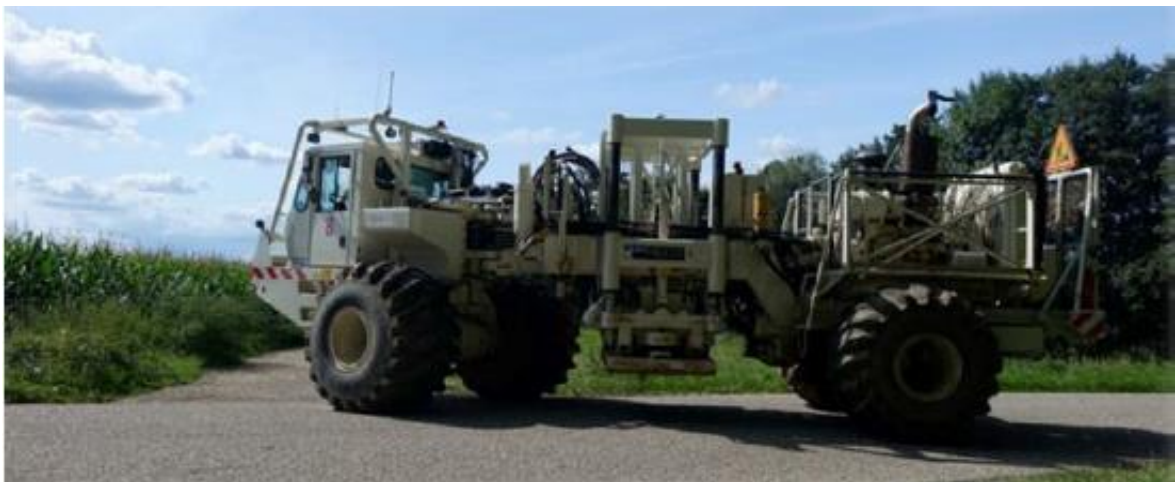
Figure 6 Camion-vibrateur type M26
