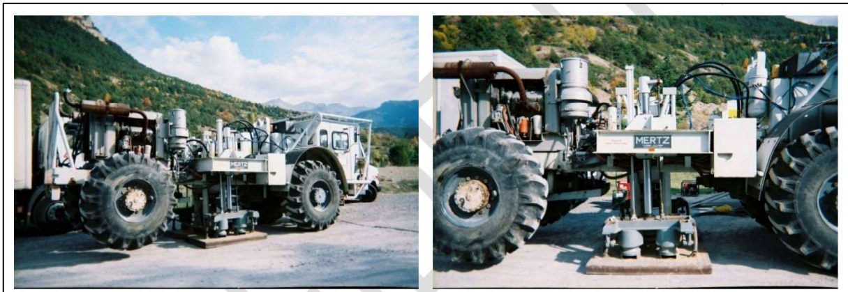
Figure 48 : Exemple de camions utilisés en sismique (Source : Fonroche Géothermie)
