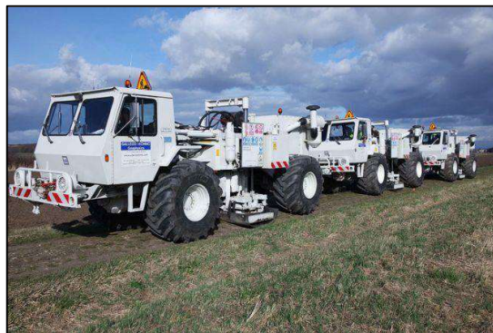
Figure 119 : Le convoi de camions vibrateurs sonde le sous-sol de la Limagne en Puy-de-Dôme, « Source : LA MONTAGNE, 2017 »
