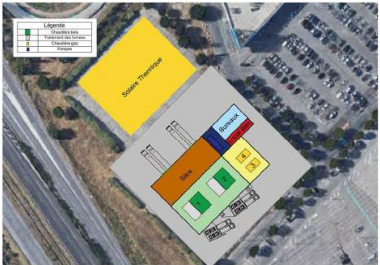
Figure 33 : Plan d'implantation chaufferie biomasse VL
