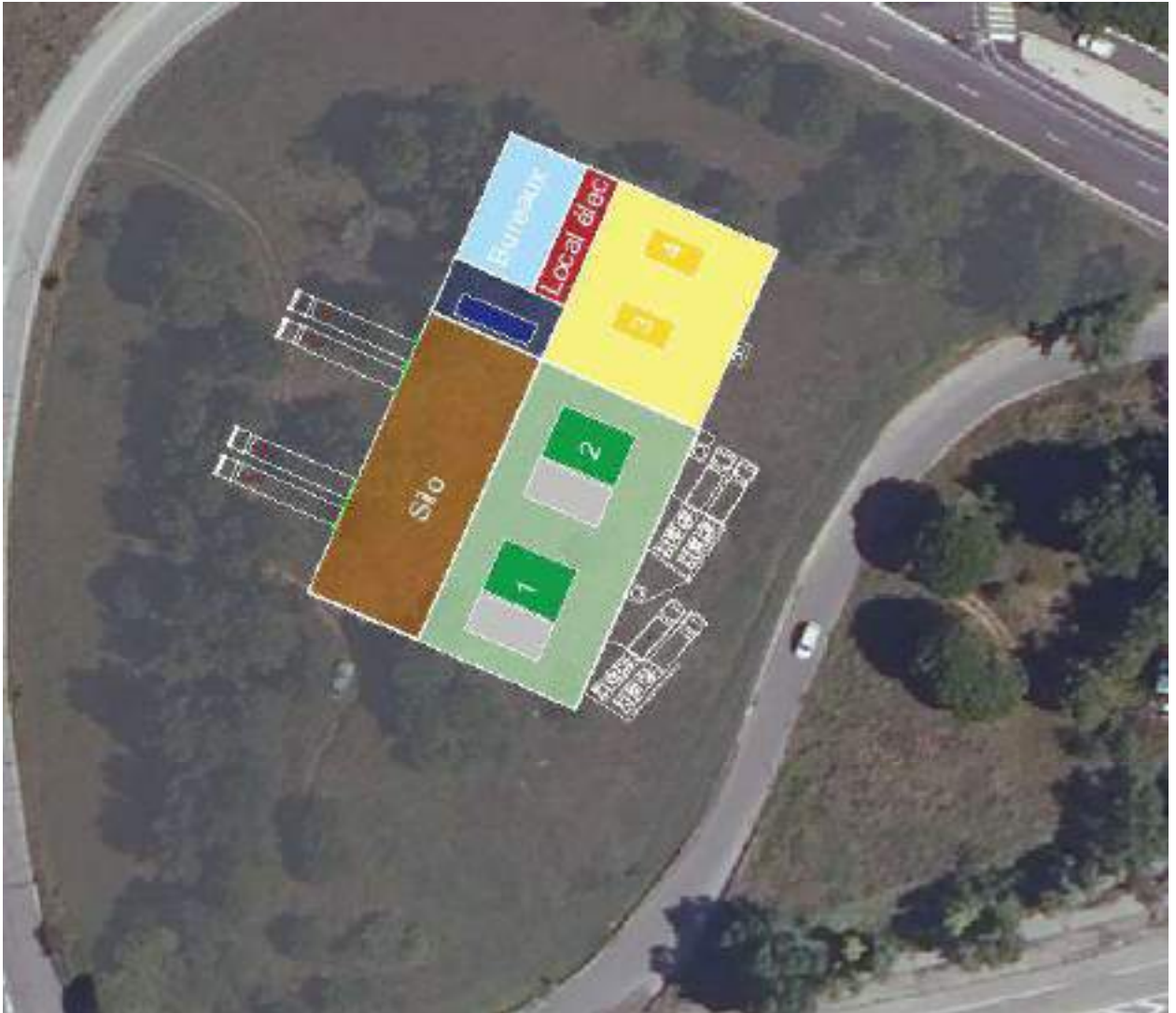
Figure 22 : Plan d'implantation Biomasse VAA Géo
