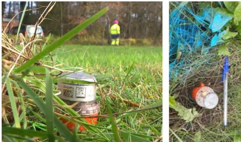
Figure 4: Géophone dernière génération (STRYDE).
