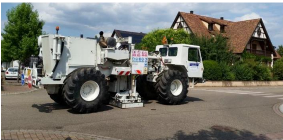
Figure 3 : Exemple de camion vibreur type Birdwagen MARK IV, insonorisé.
