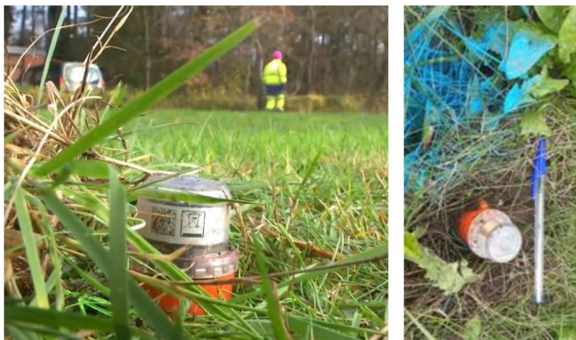
Figure 4: Géophone dernière génération (STRYDE).
