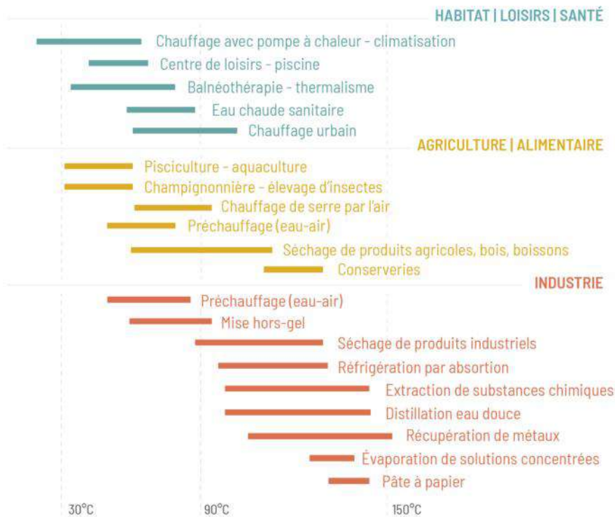
Figure 3: Utilisation de la chaleur géothermale (Source : BRGM)
