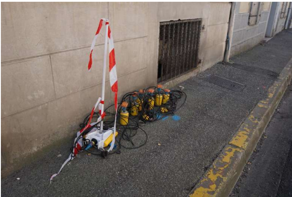
Figure 10: Géophones et méthode de déploiement sans câble
