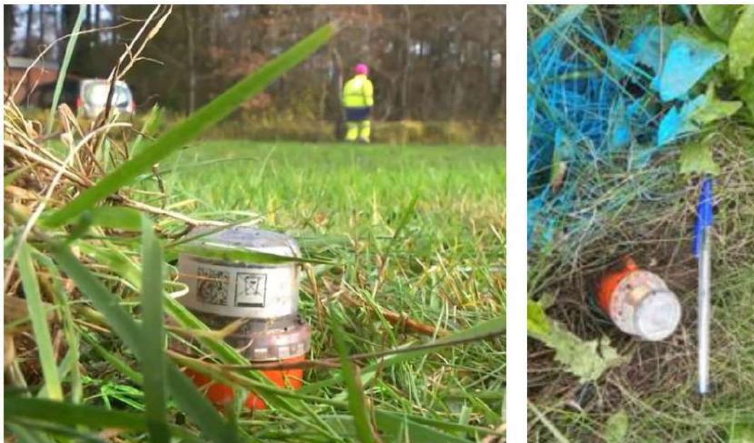
Figure 6 : Géophone dernière génération (STRYDE).
